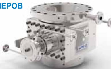
Шестеренчатые насосы высокого давления для откачки жидкостей средней и высокой вязкости из реактора. Увеличенное впускное отверстие обеспечивает равномерный приток продукта к шестерням даже при самовсасывании, при чрезвычайно низком кавитационном запасе насоса или малом расходе.
