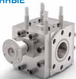
Шестеренчатые насосы для экструзии и увеличения давления в трубопроводе для работы с жидкостями средней и высокой вязкости. Насосы с электрическим или гидравлическим обогревом. Используются в процессах с высоким давлением на линии всасывания, когда необходимо повышение давления в системе из-за потерь на фильтре и в трубопроводах.
