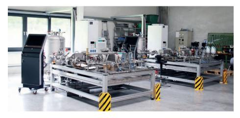
standsüberwachung der Pumpen zur Verfügung. Durch die flexible Gestaltung des mechanischen Aufbaus kann das Prüffeld zudem leicht und schnell an neue Herausforderungen angepasst und um zusätzliche Messaufgaben erweitert werden.
