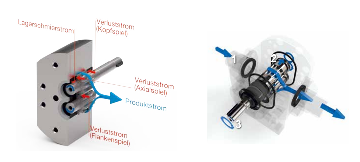
Abb. 3: Produkt- und Verlustströme in der Zahnradpumpe
