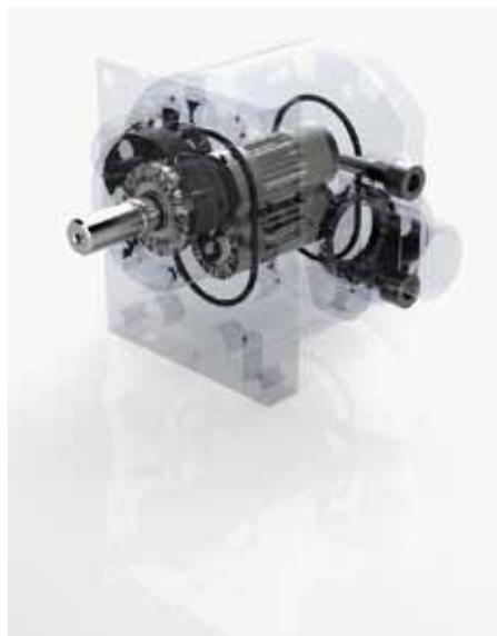
Da die Pumpe nur einen geringen Druck von 7 bar aufbauen muss, kann Kohle als Lagerwerkstoff eingesetzt werden
