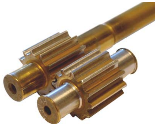
Abb. 7: Durch Überlastung verschlissene Zahnräder aus Hastelloy
