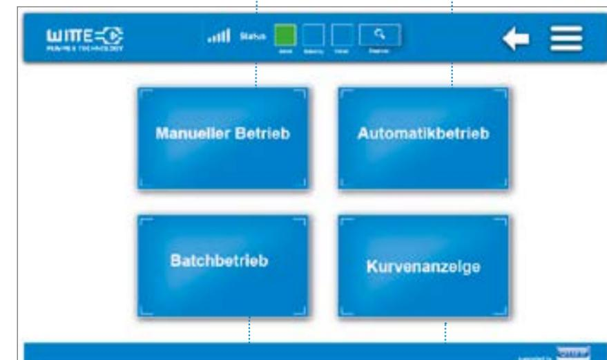
Der Batchmodus ist selbstlernend, was bedeutet, dass die Steuerung beispielsweise den Nachlauf der Pumpe nach Abschaltung berücksichtigt und entsprechend kompensiert.
