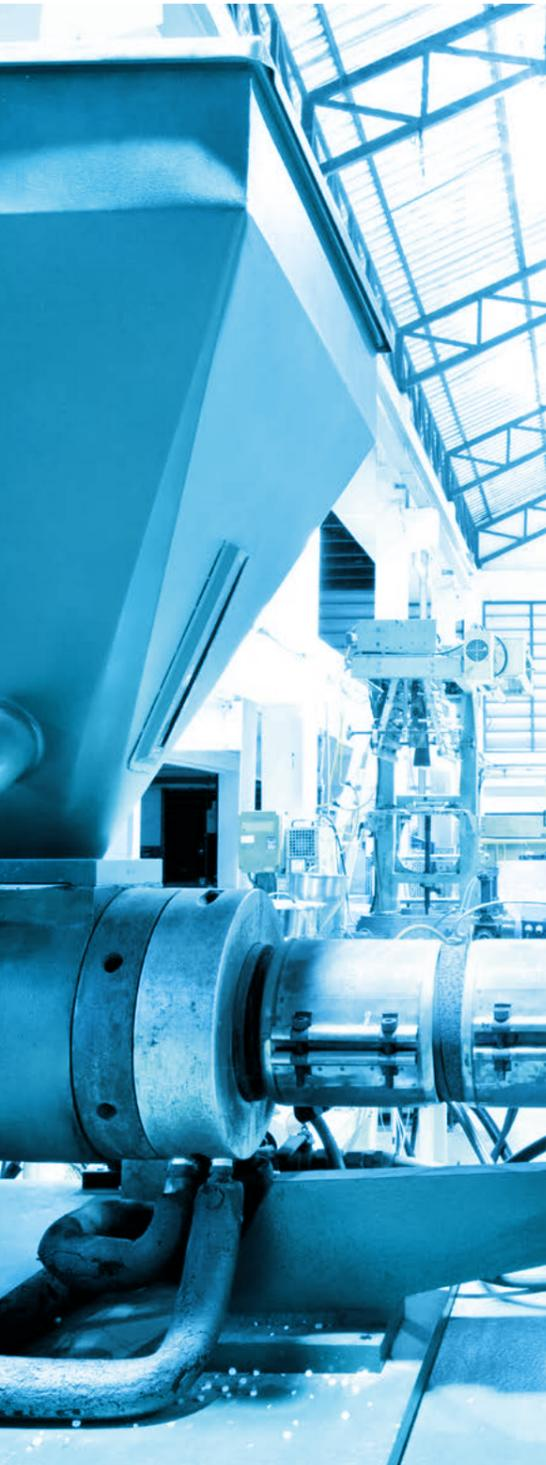
Die Schnellfarbwechsel-Version der ExtruCore® Baureihe eignet sich insbesondere für Anwender in der Masterbatchherstellung. Die Pumpe ist so konzipiert, dass bei einem Produktwechsel die Pumpe nicht gestoppt werden muss. Durch Einstellschrauben kann der Lager-schmierstrom umgelenkt werden und wird so aus der Pumpe ausgeführt.
